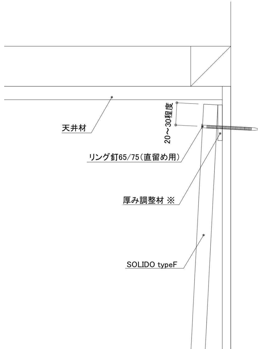
※最上段の傾きを下段の傾きに合わせるように厚みの調整を行う
