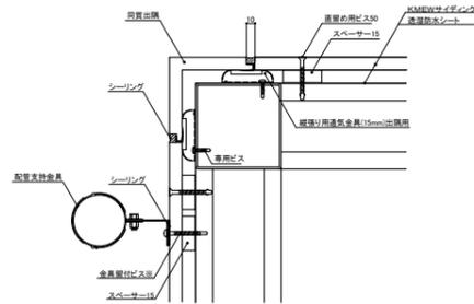
※配管支持金具留付ビスは縦打ちを確保して取り付けてください。
